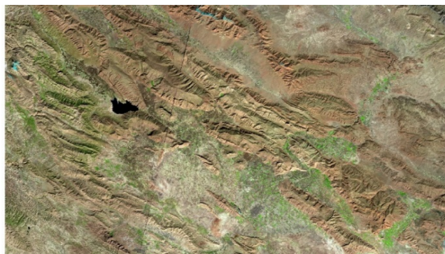
شکل ۱- تصویر ماهواره لندست ۸ از کل منطقه مرودشت و پاسارگاد حاصل از تلفیق باندهای ۷ و ۵ و ۳ با باند پانکروماتیک با قدرت تفکیک ۱۵ متر
